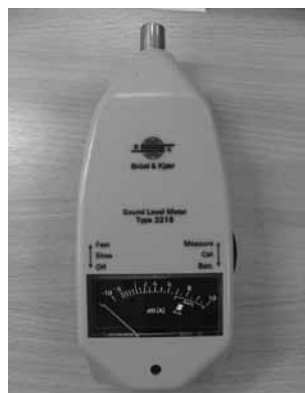
Joonis 6. Mõõtmised viidi läbi müramõõturiga Brüel & Kjaer Sound Level Meter Type 2219. (J. Zabellevitši foto)
