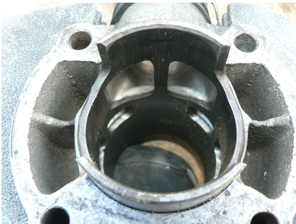
Lisa 3. Sisselaskeavad ja mootori silinder. (Moskva mootor)
