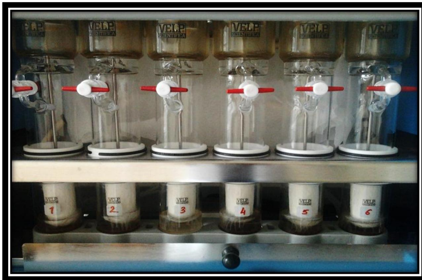
Joonis nr 7. Ekstraktsiooniprotsess Soxhleti aparaadiga
