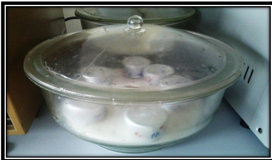
Joonis nr 4. Kaalukausside asetamine eksikaatorisse pärast kuivatust (samm 9)
