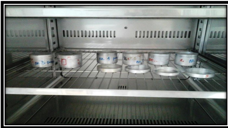
Joonis nr 2. Kaalukausside asetamine kuivatuskappi niiskusesisalduse analüüsiks (7. samm)
