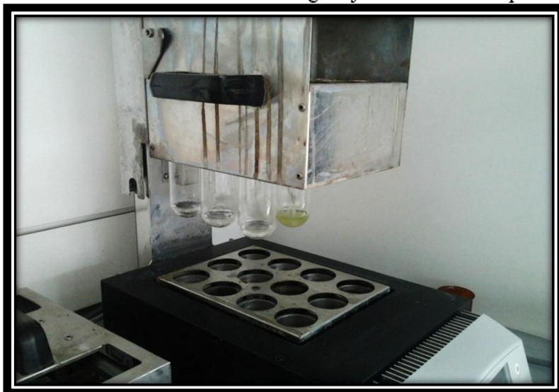
Joonis nr 9. Värvitu reaktsioonisegu Kjeldahli kolbides pärast keemist
