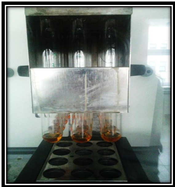
Joonis nr 9. Värvitu reaktsioonisegu Kjeldahli kolbides pärast keemist
