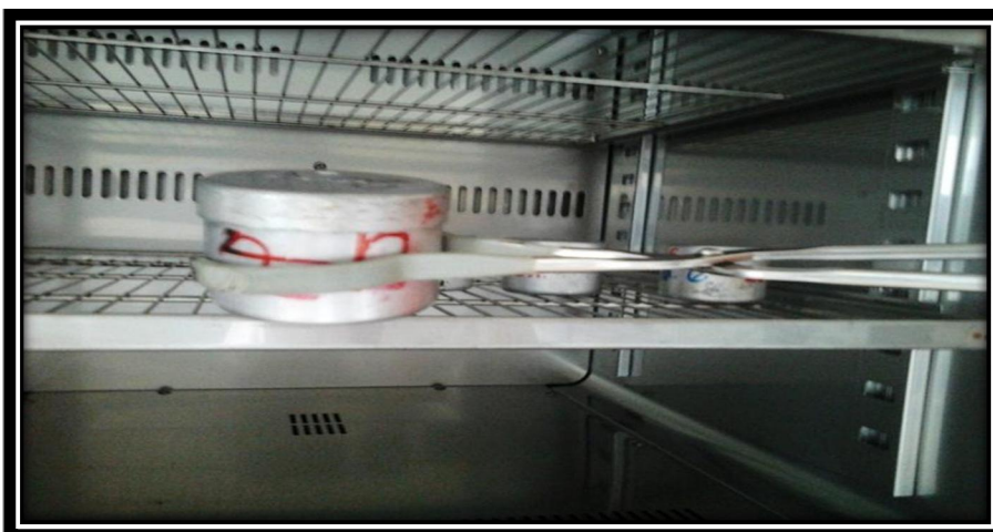
Joonis nr 3. Kaalukausside väljatõstmine tiiglitangidega (8. samm)
