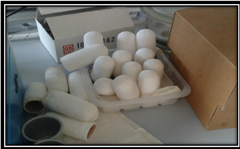
Joonis nr 6. Tselluloosist ekstraktsioonitopsid kasutatud eksperimendis
