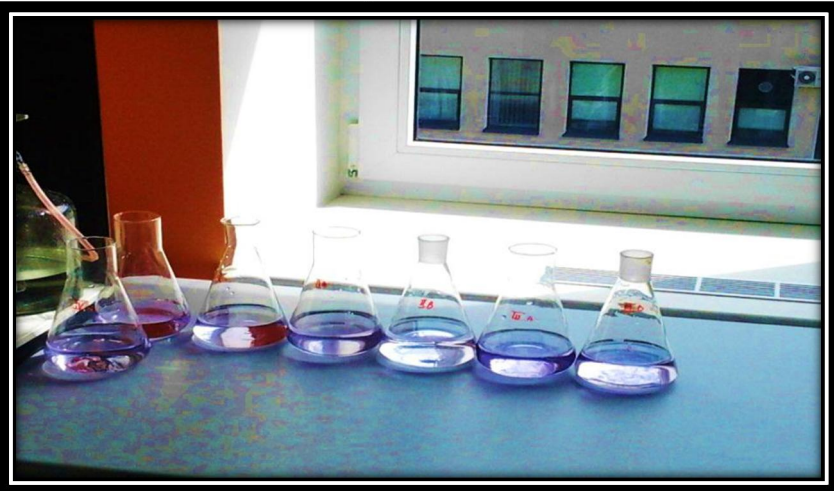
Joonis nr 12. Tagasitiitrimise tulemus vastuvõtukolvis
