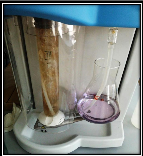
Joonis nr 11. Destillatsiooni protsessi tulemus enne tagasitiitrimist
