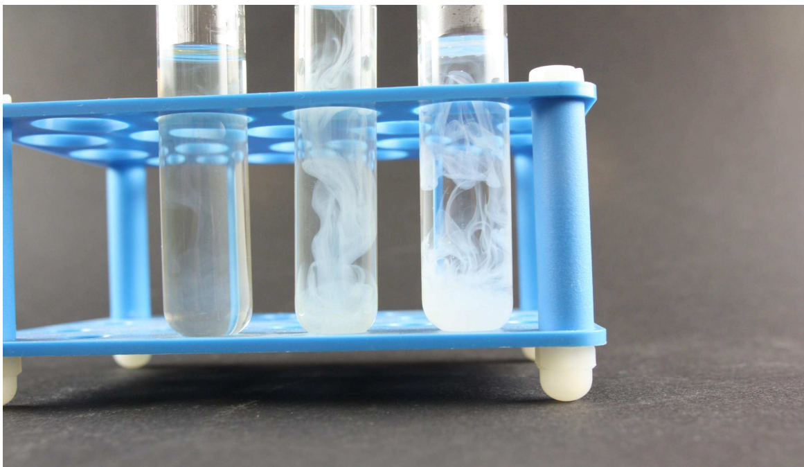
Joonis 4. Hõbenitraadi katse: vasakus klaasis on elektrolüüsitud leiu leotusvedelik, keskmises põletusmeetodi leiu leotusvedelik ja parempoolses on kraanivesi. Hõbenitraat reageerib sooladega, selle käigus tuleb piimjas hägu. Autori foto (2014)
