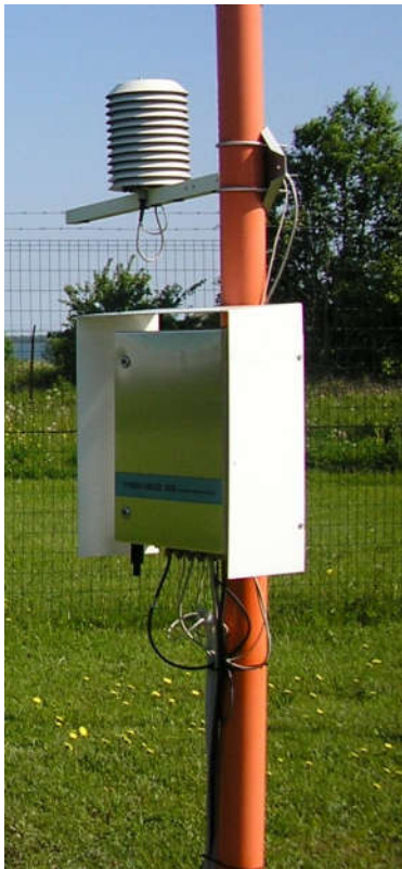
Joonis 5. Õhutemperatuurisensori kaitsekilp ( http://www.ilmateenistus.ee )
