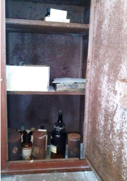
Joonis 8. a. Teraskapp, kus oli hoiustatud osa happeid ja muid ohtlikumaid aineid. b. Metallpurgid, mille roostetamist kiirendasid tõenäoliselt lähedal asuvatest happe anumatest tulevad aurud. (autori foto, 05.02.15)
