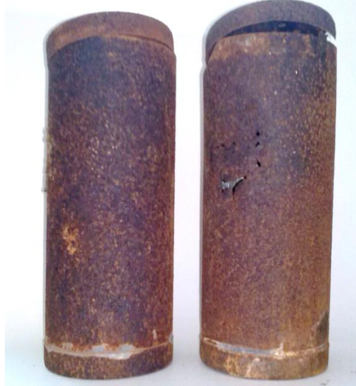
Joonis 8. a. Teraskapp, kus oli hoiustatud osa happeid ja muid ohtlikumaid aineid. b. Metallpurgid, mille roostetamist kiirendasid tõenäoliselt lähedal asuvatest happe anumatest tulevad aurud. (autori foto, 05.02.15)
