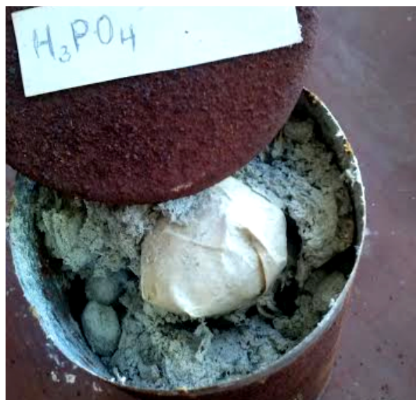
Joonis 9. Asbest anumate ümber; osade ainete ohutu säilitamise eesmärgil oli aine purk pandud metallpurki ja täidetud seest asbestipuruga. Tänapäevastes laborites seda enam ei tehta. (autori foto, 05.02.15)
