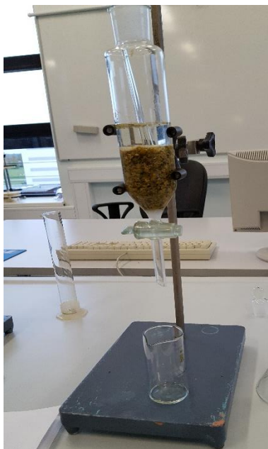
Joonis 6. Teekummeli perkolatsiooniparatuur koos droogi ja solvendiga. Autori erakogu.
