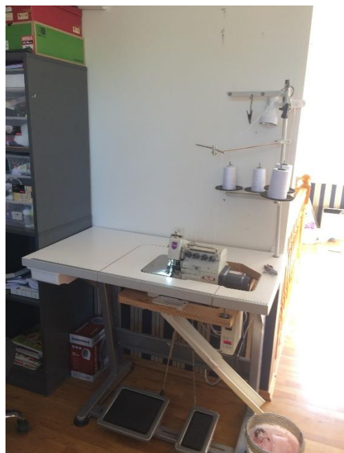
Joonis 21. 4-niidiline äärestus-ühendusmasin Autor: G.L. Uuk (21.06.2018)
