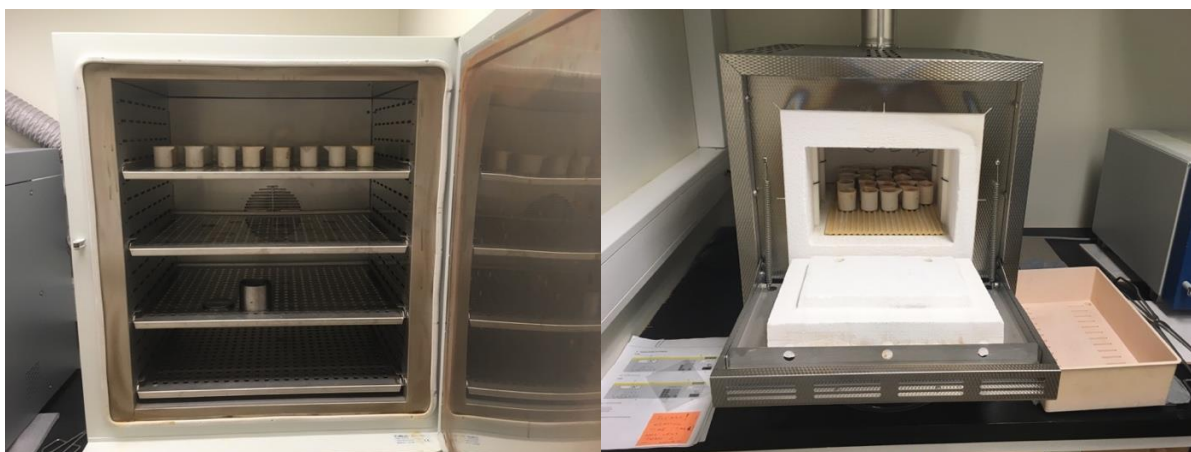
Pildid kuivatuskapist ja muhvelahjust, kuhu tiiglid paigutati. (Autori erakogu)
