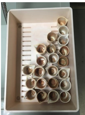
Joonis 9. Tiiglid pärast muhvelahjust välja võtmist (Autori erakogu)
