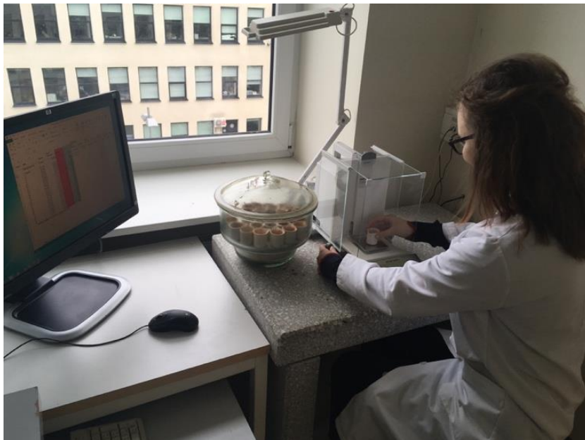
Joonis 10. Tiiglite kaalumise- ja salvestamisprotsess (Autori erakogu)
