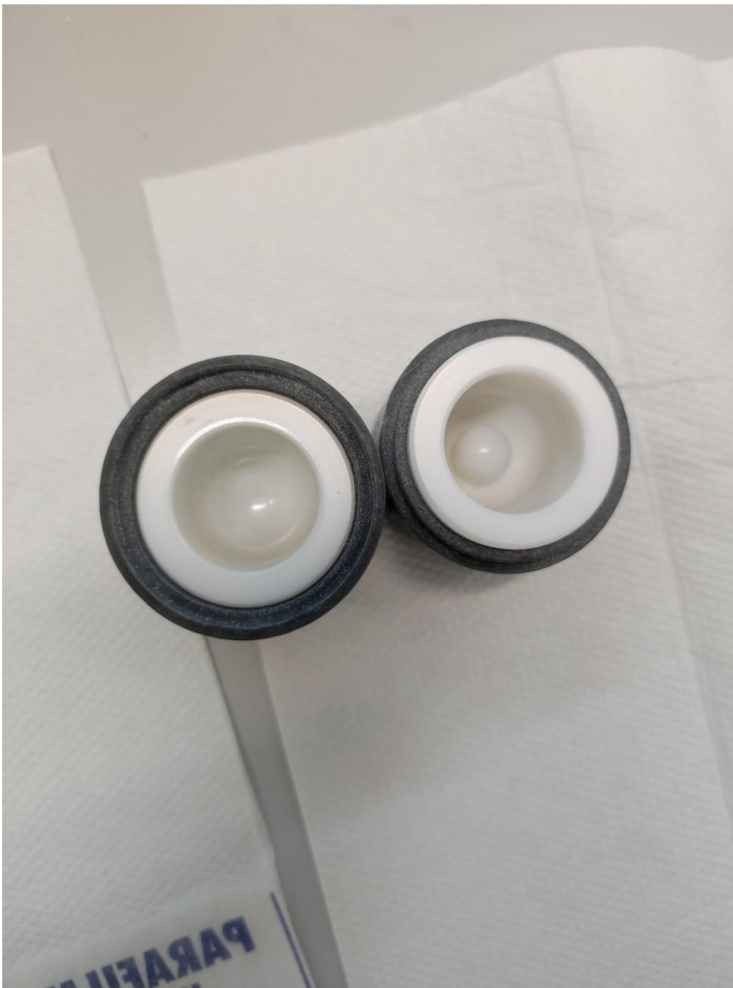
Pilt 2. Elektrilise kuulveski kapsel ja kuul. Autor: Jaagup Kuuskla
