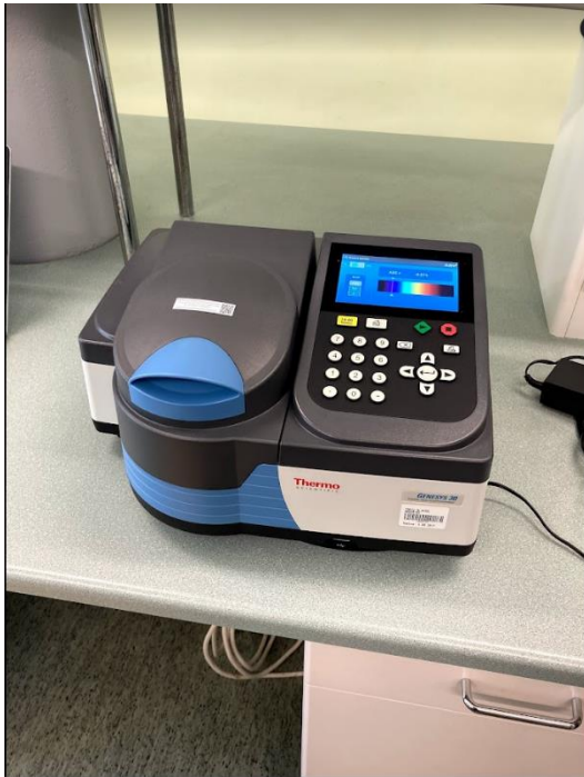
Joonis 9. Spektromeeter Genesys30, Thermo Scientific (autori foto).
