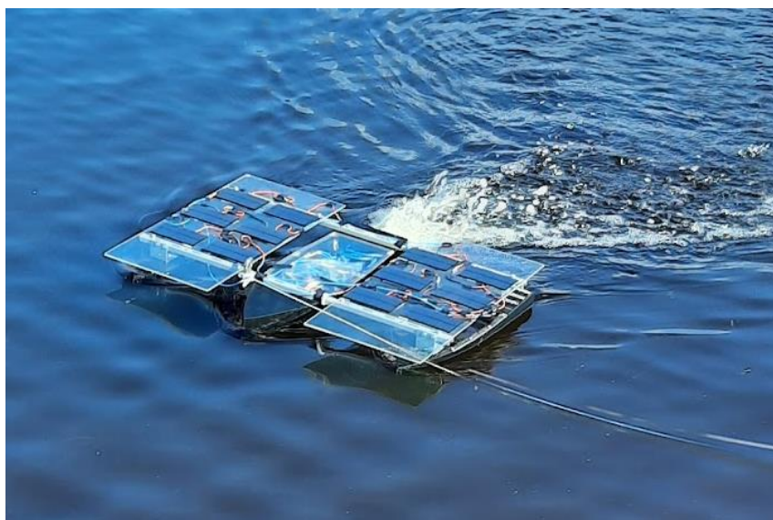
Joonis 17. Mobiilsete päikesepaneelide test trimaraanil Pirita jõel (Foto: autori erakogu)
