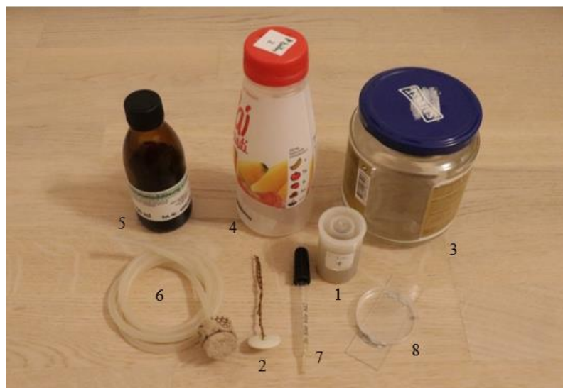
Joonis 14. Töövahendid: 1 – proovikogumistops, 2 – kolb, 3 – klaaspurk, 4 – setituspudel, 5 – Lugoli lahus, 6 – vee voolamise süsteem, 7 – mõõtpipett, 8 – alusklaasi külge kinnitatud Petri tass (autori foto)
