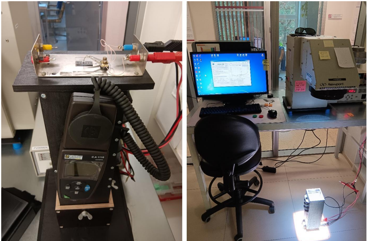
Joonis 14. Süsteem eritingimustes mõõtmiseks. Vasakul: reguleeritava kõrgusega korpus, luksmeeter, mõõteobjekti alus elektroodidega. Paremalt: mõõtmine AM 3.0 tingimustes
