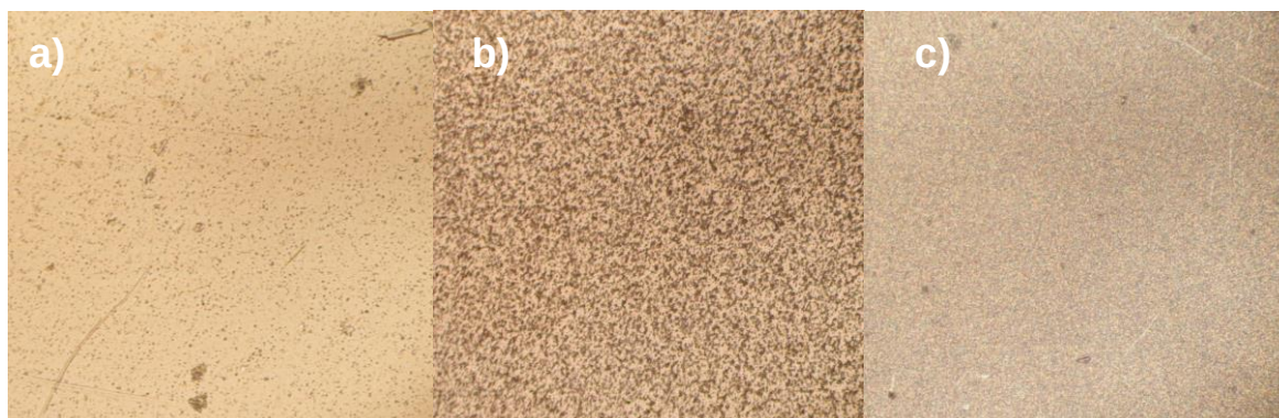
Joonis 6. Läbi optilise mikroskoobi vaadeldud a) Al, b) Alx ja c) Aly anoodid, mille pildistamiseks kasutati helevälja kontrasti meetodit, peegelduvat valgust, 50× objektiivi, pildi laius on 174 mikromeetrit
