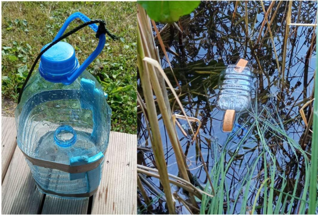
Joonis 20. Ujuripüünis külgedele kinnitatud ujukitega (vasakul) ja püügile asetatud ujuripüünis ottesse kinnitatud ujukitega (paremal; autori fotod)
